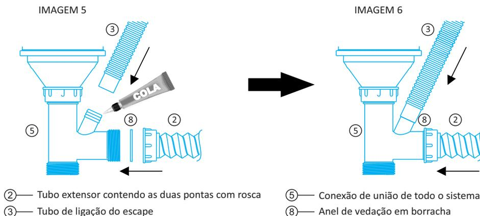
Encaixe o tubo de ligação do escape (item 3) na conexão (item 5) conforme mostrado na IMAGEM 5, fazendo com que o tubo cubra toda a parte dentada da conexão. Se necessário, utilizar cola PVC/cola canos para vedação total (esta cola não acompanha o produto). Em seguida conecte o item 2 ao item 5 utilizando um anel de vedação (item 8) dando o aperto necessário para vedação. O resultado final fica como ilustrado na IMAGEM 6.
