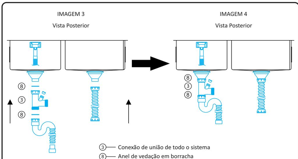
Separe todas as peças necessárias para interligação, conforme mostrado na IMAGEM 3. Após a instalação das válvulas o próximo passo é a fixação da conexão de união (item 3) à válvula da cuba. Inicie a montagem pela cuba menor. É na válvula da cuba menor que será encaixado o tubo de ligação do escape. Para realizar a vedação use o anel de vedação (item 8). Dê o aperto necessário para vedação.
