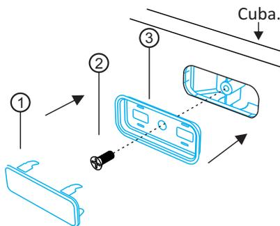
Encaixe o suporte em aço inox (item 3) pela parte de dentro da cuba e aparafuse (Item 2) dando o aperto necessário para vedação. Cuidado para não apertar em excesso, o que poderá danificar o produto. Após dar o aperto adequadamente, encaixe a capinha de acabamento finalizando o processo de instalação do cachimbo do escape.
