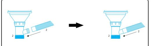
Conecte o tudo de ligação do escape (item 1) a conexão de união (item 2) conforme imagens ilustrativas.
