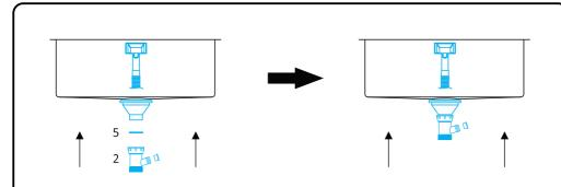
Após a instalação das válvulas o próximo passo é a fixação da conexão de união (item 2) à válvula da cuba. Para realizar a vedação use o anel de vedação (item 5). Dê o aperto necessário para vedação.
