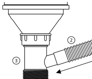
Encaixe o tubo de ligação do escape (item 2) na conexão (item 3) conforme mostrado na IMAGEM 5, fazendo com que o tubo cubra toda a parte dentada da conexão. Se necessário, utilizar cola PVC/cola canos para vedação total (esta cola não acompanha o produto). O resultado final fica como ilustrado na IMAGEM 6.
