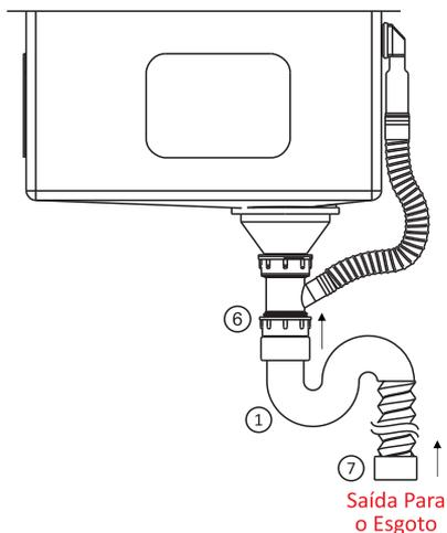
Por fim, conecte o sifão (item 1) à saída de esgoto utilizando um anel de vedação (item 6) para a vedação. O sifão que acompanha o produto, representado pelo item 1 e item 4, são de padrão americano, ou seja, a ponta que ficará destinada a entrada de esgoto é apenas encaixada adentro do cano. Caso necessário, poderá substituir os itens 1 e 4 por um sifão corrugado convencional brasileiro.
