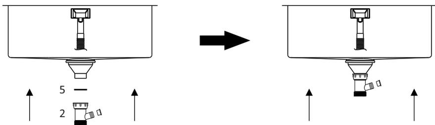
Após a instalação das válvulas o próximo passo é a fixação da conexão de união (item 2) à válvula da cuba. Para realizar a vedação use o anel de vedação (item 5). Dê o aperto necessário para vedação.
