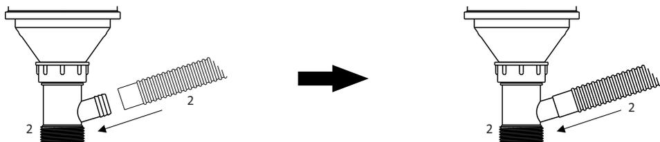
Conecte o tudo de ligação do escape (item 1) a conexão de união (item 2) conforme imagens ilustrativas.
