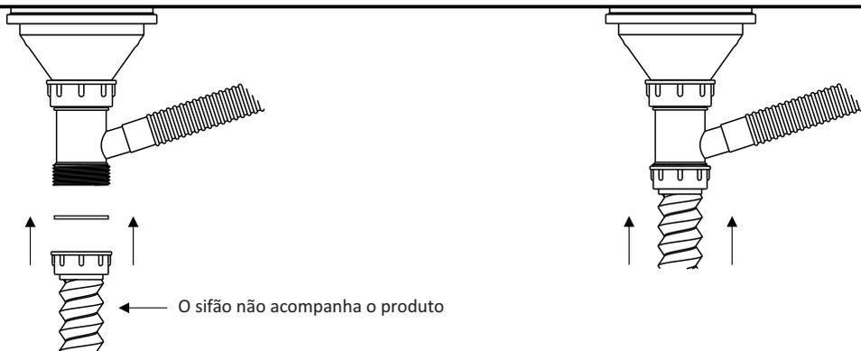
Para finalizar a instalação hidráulica, conecte um sifão (o sifão não acompanha a cuba) à válvula e ligue na rede de esgoto.
