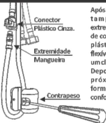
Após fixar o misturador ao tampo, conecte a extremidade da mangueira de cor preta ao conector de plástico na cor cinza do flexível mais curto até ouvir um clique. Depois fixe o contrapeso próximo a curvatura formada pela mangueira, conforme ilustração.
